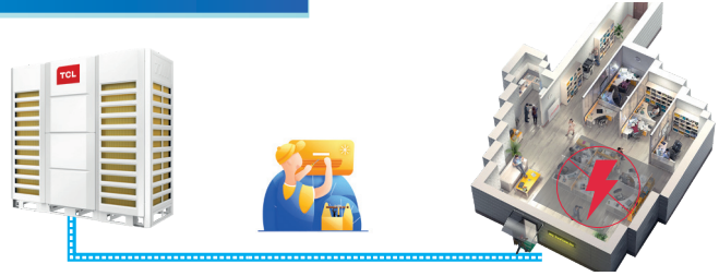
Bakım için 2 iç ünite ayrı ayrı kapatılabilir.
